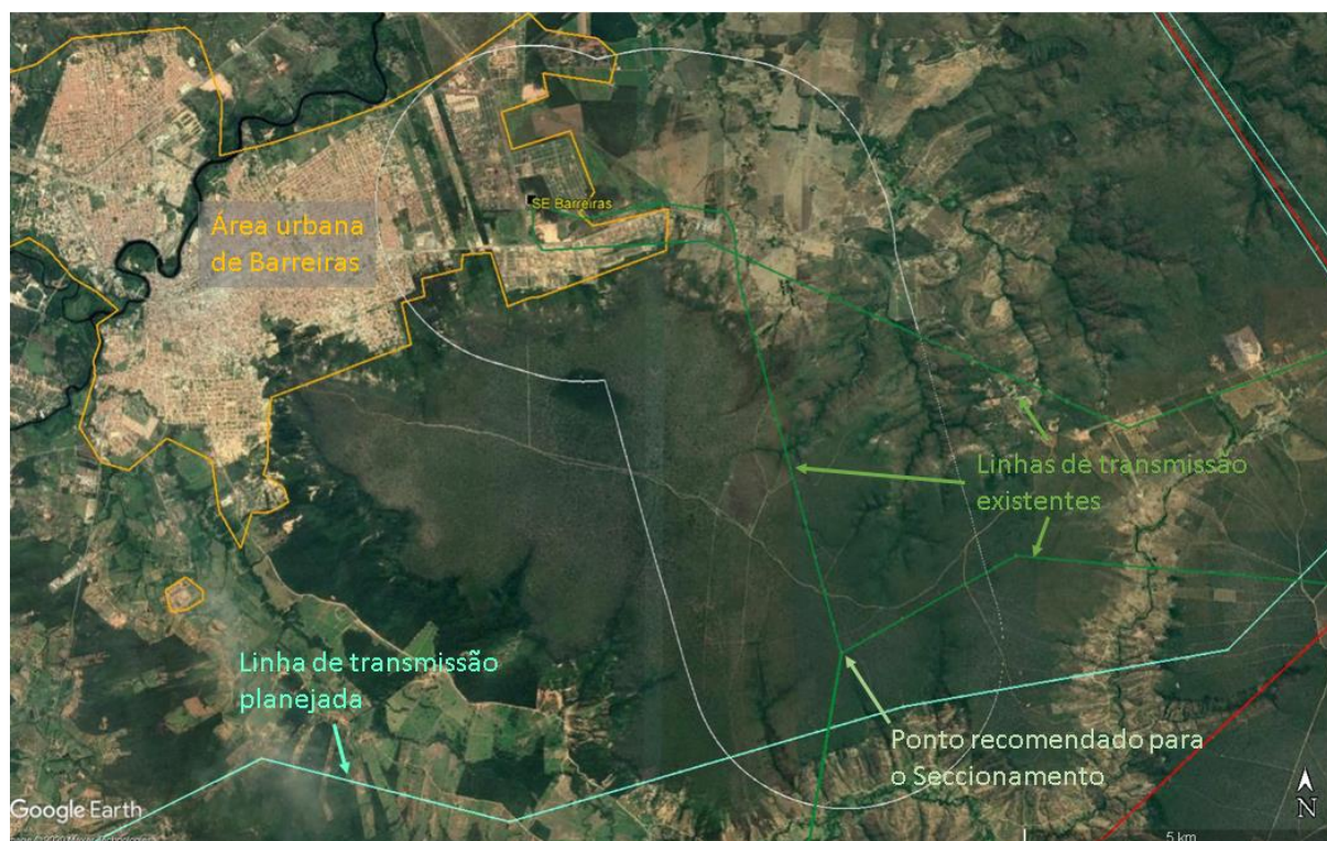
Figura 2 – Corredor do Seccionamento da LT 230 kV Barreiras II – Rio Grande II na SE Barreiras
